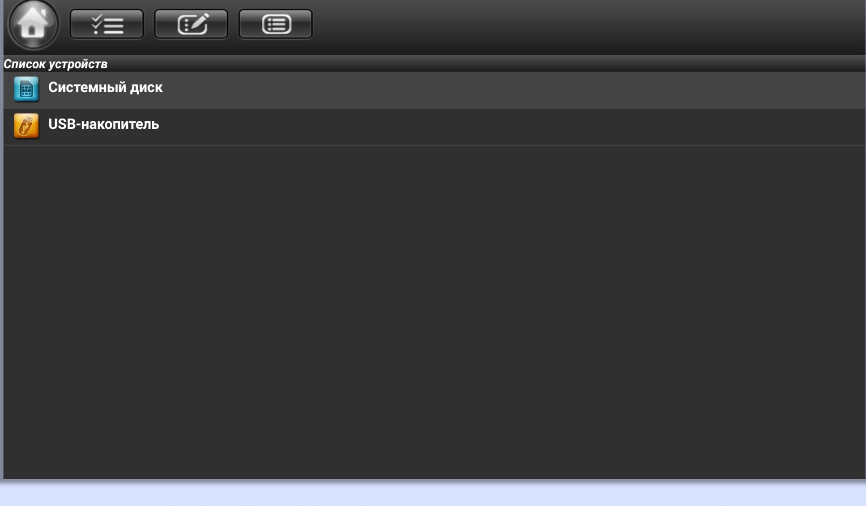
Для цього зовнішній носій необхідно підключити до приставки через порт USB. Потім за допомогою клавіш ПДК вибрати розділ «Файли» і натиснути клавішу «OK». Після цього з'явиться таблиця пристройв: системний диск та підключений зовнішній USB-накопичувач.
